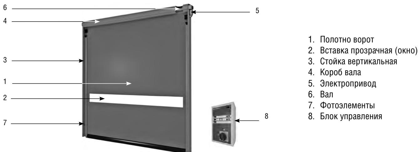
**Примечание.** Полотно ворот изготавливается из ПВХ-материала, армированного одним слоем полиэстера. Вертикальные стойки и короба изготавливаются из алюминиевого сплава.
