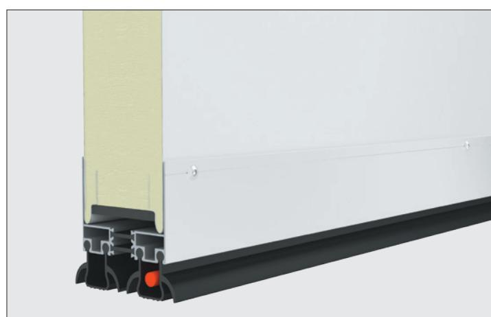
□ Нижний алюминиевый профиль с терморазрывом препятствует образованию конденсата и наледи. Двойной уплотнитель нивелирует неровности пола, обеспечивает хорошую герметизацию. При использовании опции «обогреваемый контур проема» нижняя кромка полотна оснащается нагревательным элементом.
